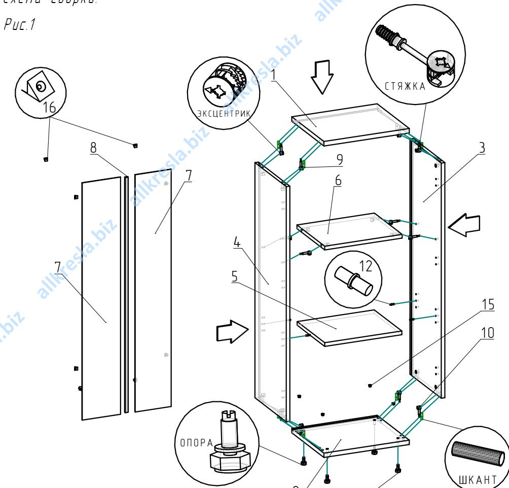
1. Вставьте шканты во все глухие отверстия диаметром 8 мм. В глухие отверстия диаметром 5 мм вберните штоки эксцентриковых стяжек. Во все глухие отверстия диаметром 15 мм вставьте эксцентрики. Стрелка на эксцентрике должна быть направлена в сторону штока.
